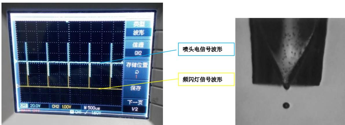
而当我们改变频闪灯的时间相位的时候，也就是改变每个周期内喷头电信号波形与频闪灯信号波形发生的相对时间，例如延时  $50\mu\text{s}$ ，即频闪灯会在液滴滴落  $50\mu\text{s}$  后闪烁，此时相机便记录液滴发生  $50\mu\text{s}$  后的空间状态。**补充**：不同的时间相位，我们所拍摄到的液滴所在的空间位置是不同的。
